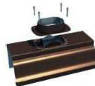
Заглушка водосточного желоба фиксируется на месте 4-мя заклепками и герметиком.
